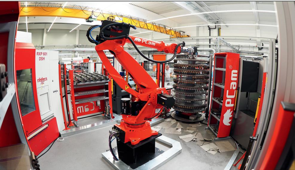
**Fräsen, Erodieren und Messen:** In der neuen Fertigungszelle im Formenbau arbeiten ein Bearbeitungszentrum, drei Senkerodiermaschinen und eine Messmaschine Hand in Hand – und das 24/7. (© Hanser/Schröder)
