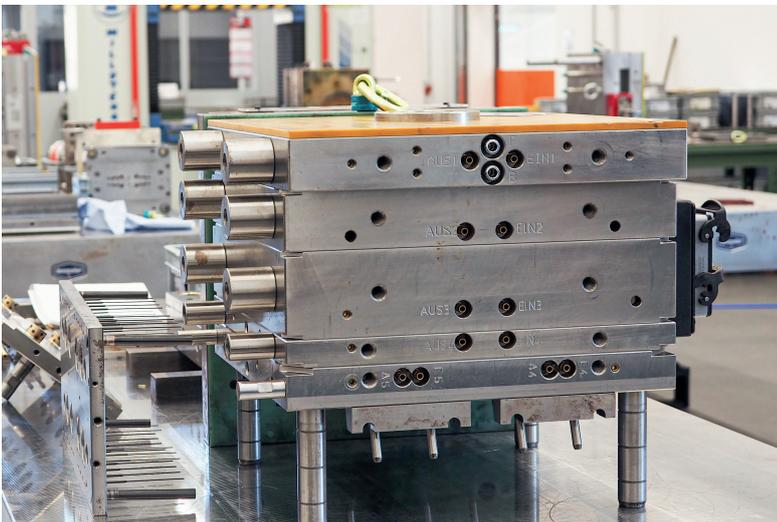
**„Spart eine Menge Arbeit“:** Die Formplatten werden von Meusburger inklusive seitlicher Bearbeitung wie Kühlbohrungen und Gewinden geliefert. (© Hanser/Schröder)
