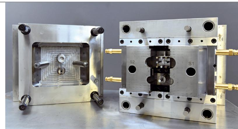
**Präzision in gehärtetem, teils poliertem Stahl** für den Bau haptisch angenehmer, weicher Reinigungswürfel: Der Kunde hat die Komplexität des Herstellungsprozesses nicht im Blick – muss er auch nicht. Aber ohne die Idee des Start-ups und ohne die Erfahrung des Entwicklers und Werkzeugbauers kommt das Produkt nicht in die Welt
